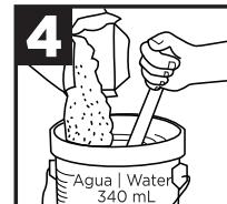
En 340 mL de agua limpia, agregue el contenido de la bolsa de 2 kg poco a poco y mezcle hasta obtener una pasta homogénea.
