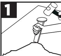
Limpiar la grieta con espátula metálica o martillo y cincel, removiendo partículas flojas o sueltas, y abriendola mínimo a 3 mm de ancho. En aplicaciones sobre yeso abrir la grieta a 10 mm de ancho y hasta no llegar al muro de concreto o cemento.
