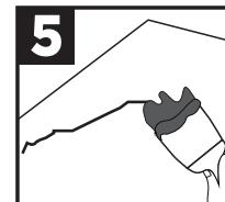
Usando la espátula flexible aplique suficiente RESANADOR fresco sobre la grieta haciendo presión para llenarla y compactarla por completo. Retire el exceso fresco y después de 5 minutos aplique la capa de RESANADOR con una esponja semi humeda. En superficies de yeso aplique y deje 3 mm de profundidad sin llenar, después de 4 horas rellene los 3 mm con yeso fresco.
