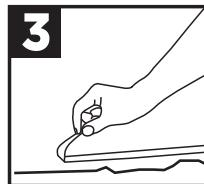
Para reparaciones de grietas en superficies lisas como yeso, coloque cinta de enmascarar a ambos lados de la grieta antes de comenzar. En estos casos, abrir la grieta a 10 mm de ancho y hasta llegar al muro base. Luego siga las instrucciones del punto 5.
