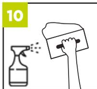
Para una apariencia altamente pulida rociar durante el proceso de fricción de llaneado Cemix Bond-Ultra diluida en una proporción de 3 a 1. | *For a highly polished appearance spray during friction troweling Cemix Bond-Ultra diluted 3 to 1.*
