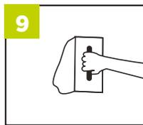
Aplique la segunda capa más delgada que permita pulir la superficie mediante fricción de llana. | *Apply a thin second layer that allows to polish the surface by friction with the trowel.*
