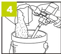
Agregue el contenido del saco 20 kg en forma gradual durante el proceso de batido. | *Gradually add one bag of product while stirring to mix the powder and water*
