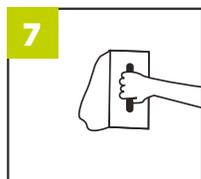
Aplique la primera capa con llana lisa con un espesor promedio de 2 mm | *Apply the first layer with a smooth trowel with an average thickness of 2 mm.*
