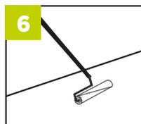
Humedecer o sellar con Cemix Bond-Ultra la superficie previo a la aplicación | *Wet or seal the surface before the product application using water or Cemix Bond-Ultra.*
